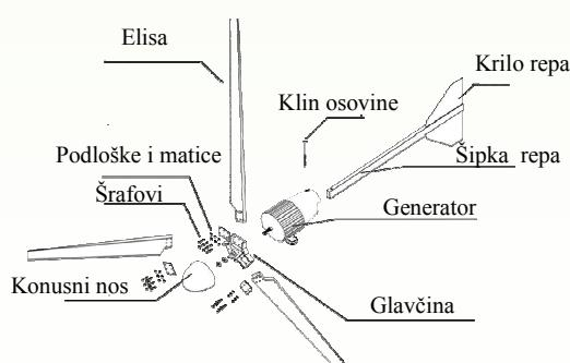
Vetrogeneratori su dimenzionisani tako da nominalnu snagu daju pri brzini vetra od 8 do 10m/s dok pri brzinama vetra od oko 12 m/s daju i do 50 % veću snagu. Takođe, imaju sistem zaštite koji se aktivira pri brzinama vetra od 40-50m/s
